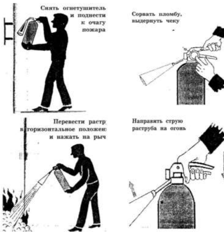
Рис. 3. Приведение в действие ручного углекислого огнетушителя.
