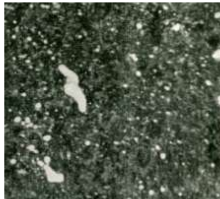
Рис.2 Микроструктура стали после заковки и многократного отпуска
