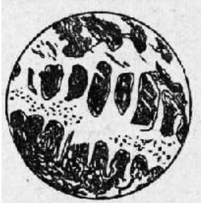
Рис. 7 Структура доэвтектического чугуна
