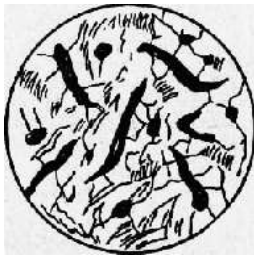
Рис. 8 Структура заэвтектического чугуна
