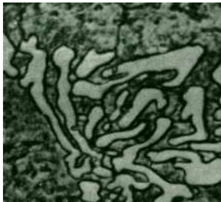
Рис.2 Микроструктура стали после отжига
