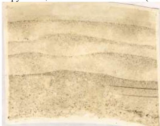
Рис. 1. Ликвация серы в стали
