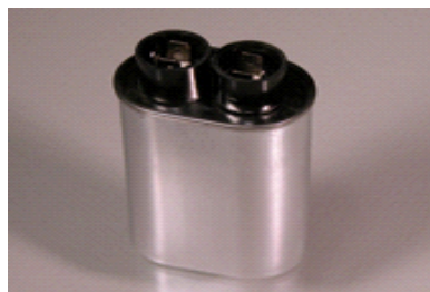
Рис.2 Высоковольтный конденсатор микроволновой печи
