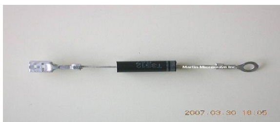
Рис. 3 Высоковольтный диод СВЧ печи
