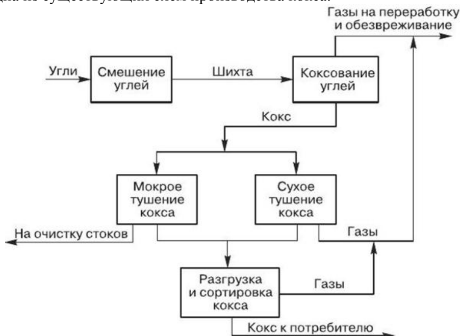
Рис. 1 – Технологическая схема производства кокса
