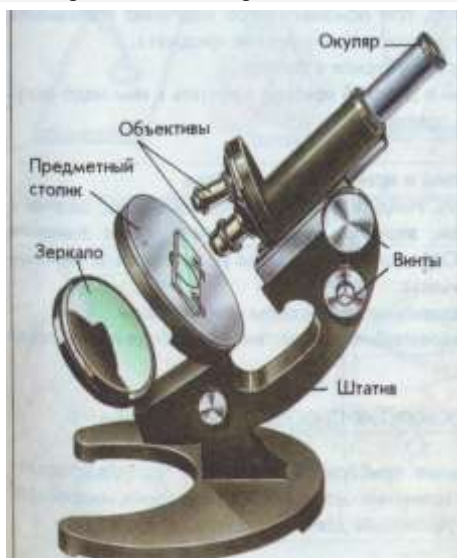
Рис. 1. Строение светового микроскопа
