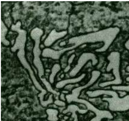
Рис.2 Микроструктура стали после отжига
