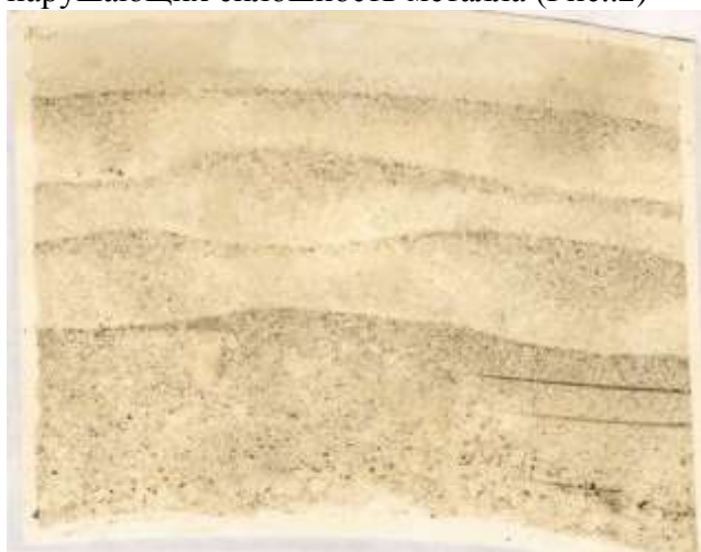
Рис. 1. Ликвация серы в стали
