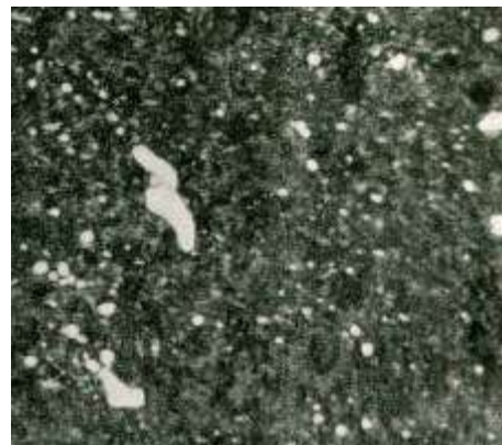
Рис.2 Микроструктура стали после закалки и многократного отпуска
