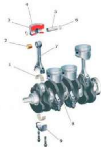
Схема КШМ: 1 - вкладыш шатунного подшипника; 2 - ступица задний провала шатуна; 3 - поршневые кольца; 4 - поршневые; 5 - поршневой палец; 6 - статорное кольцо; 7 - шатун; 8 - коленчатый вал; 9 - крышка шатунного подшипника.
