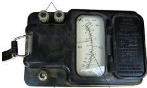
Рис. 9.8. Внешний вид мегомметра М1101М:
