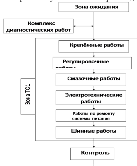
Рисунок - Схема организации технологического процесса зоны ТО-1
