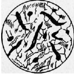
Рис. 8 Структура заэвтектического чугуна
