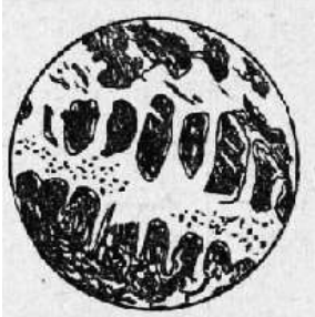
Рис. 7 Структура доэвтектического чугуна
