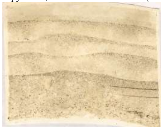
Рис. 1. Ликвация серы в стали
