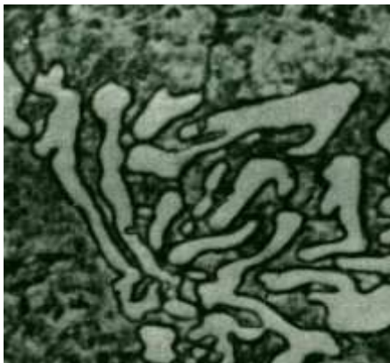
Рис.2 Микроструктура стали после отжига
