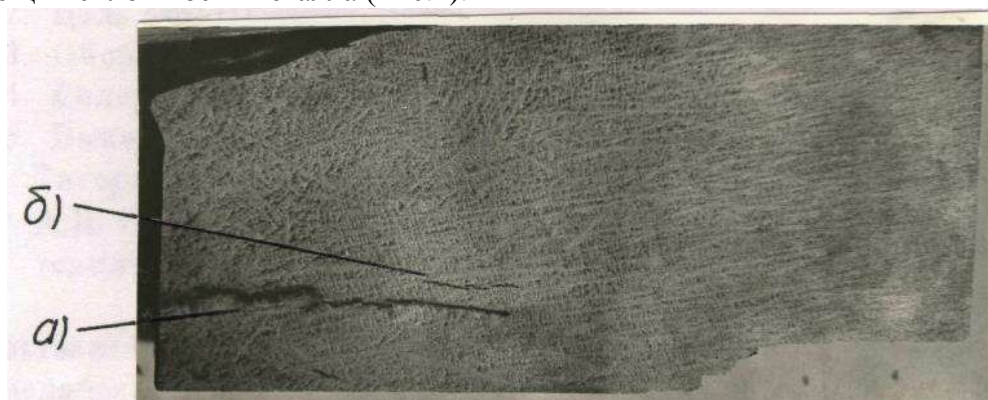
Рис. 2. Дефекты, нарушающие сплошность металла а) трещина; б) флокены
