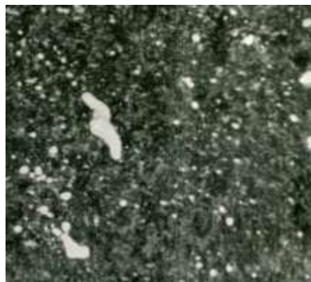
Рис.2 Микроструктура стали после закалки и многократного отпуска
