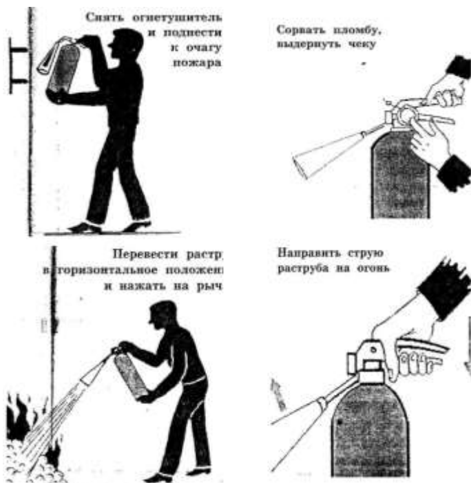
Рис. 3. Приведение в действие ручного углекислого огнетушителя.
