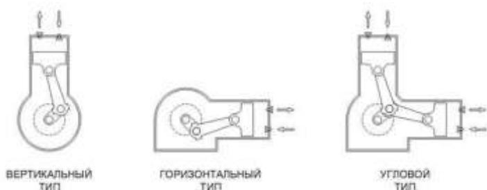
Рисунок 3а - Расположение цилиндров
