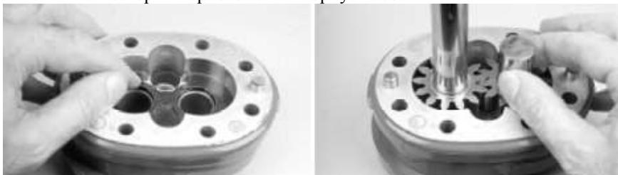
6. Установите новое уплотнительное кольцо в паз переходной пластины (боковой втулки ниже поверхности).
