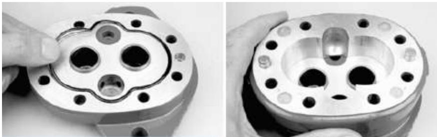
1. Во время сборки смазать все пластины, уплотнения, резервные прокладки, уплотнения вала и уплотнительные кольца. Смажьте все готовые детали и /или рабочие поверхности чистой гидравлической жидкости во время сборки.
