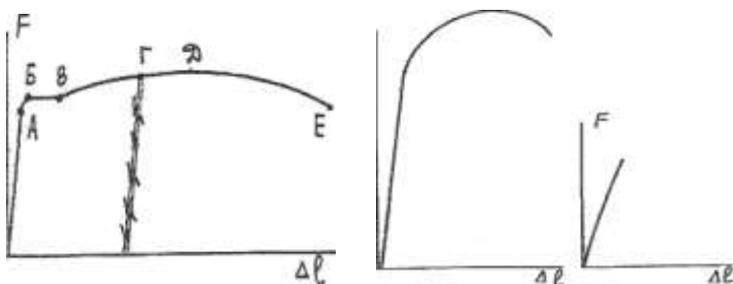
низкоуглеродистой стали ( $C < 0.30\%$ ), конструкционной стали ( $C > 0.3\%$ ) и серого чугуна приведены на рис. 2а, 2б, 2в.
