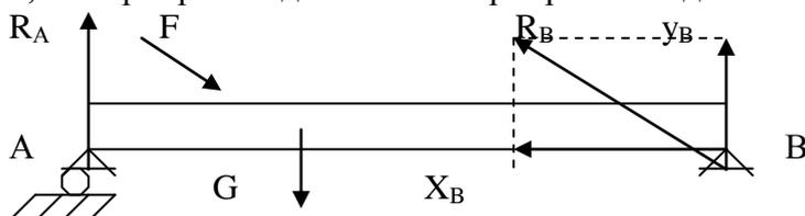
В шарнирно-подвижной опоре возникает одна вертикальная реакция.
