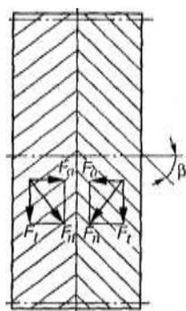
колесо, состоит из зубьями шевронным зубчатого линии зубьев называют
