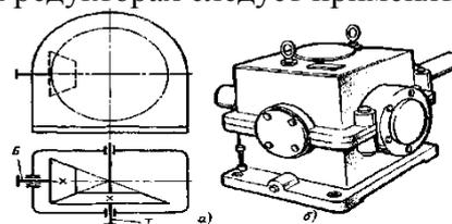
Рис. 2.4. Одноступенчатый редуктор с коническими зубчатыми колесами:
