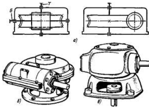
**Рис. 2.16. Червячный редуктор с вертикальным валом червячного колеса:**
