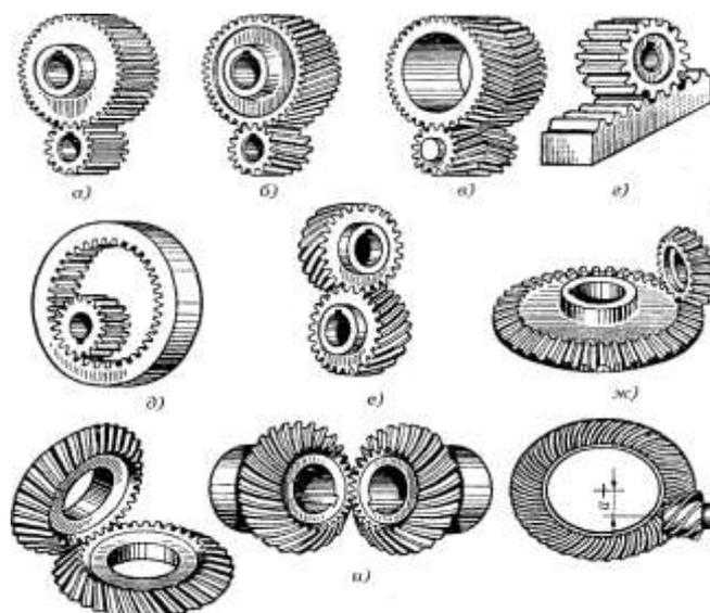
Рис. 3.1. Виды зубчатых передач: *а, б, в* — цилиндрические зубчатые передачи с внешним зацеплением; *г* — передача винт-гайка; *д* — цилиндрическая передача с внутренним зацеплением; *е* — зубчатая винтовая передача; *ж, з, и* — конические зубчатые передачи; *к* — гипоидная передача
