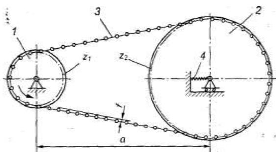
Передачу механической энергии между параллельными валами, осуществляемую с помощью двух колес — звездочек 1 и 2 и охватывающей их цепи 3, называют цепной передачей (рис. 7.1).
