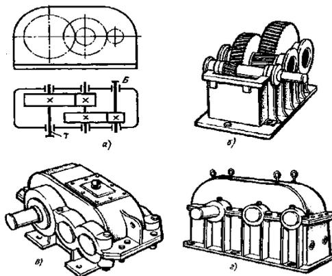
**Рис. 2.6. Двухступенчатый горизонтальный редуктор с цилиндрическими колесами:**
