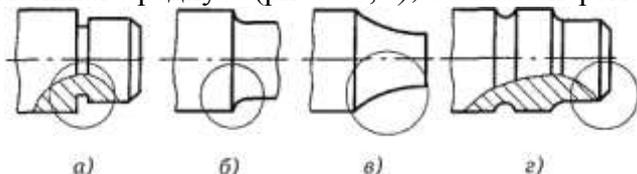
Рис. 8.6. Конструктивные разновидности переходных участков вала: *а* — канавка; *б* — галтель; *в* — галтель переменного радиуса; *з* — фаска
