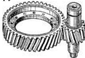
Рис. 3.36. Цилиндрическая косозубая передача
