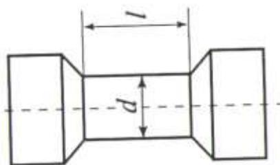
Рисунок 3. Эскиз образца
