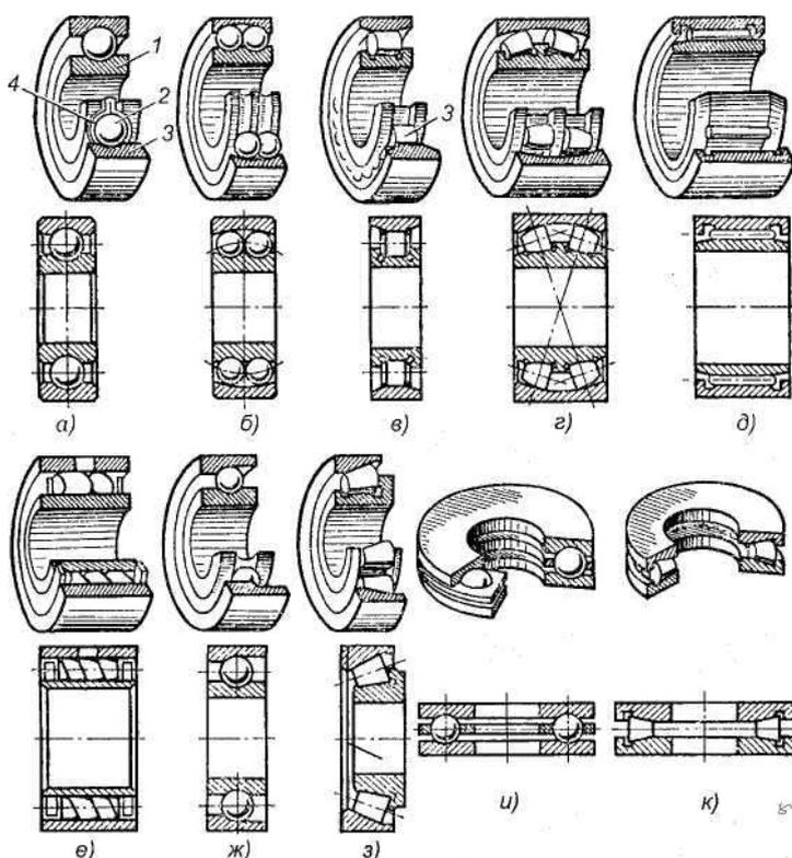
**Рис. 11.1.** Подшипники качения: а, б, в, г, д, е — радиальные подшипники; ж, з — радиально-упорные подшипники; и, к — упорные подшипники; / — внутреннее кольцо; 2 — тело качения; 3 — наружное кольцо; 4 — сепаратор
