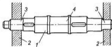
Рис. 8.1. Прямой вал: 1 — вал; 2 — опоры вала; 3 — цапфы; 4 — шейка
