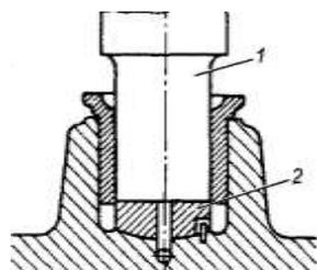
Рис. 8.4. Опора вертикального вала: 1 — пята; 2 — подпятник
