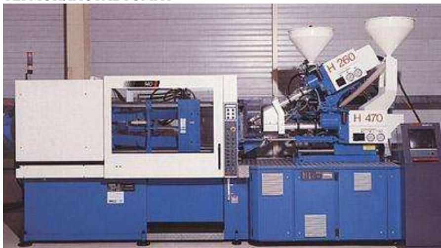
Рисунок 5.1 – Двухкомпонентный горизонтальный термопластавтомат
