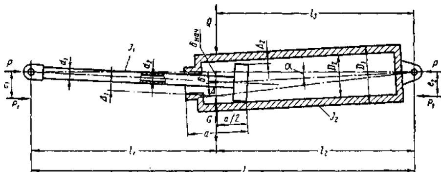
Рис. 1 Схема нагружения силового гидроцилиндра
