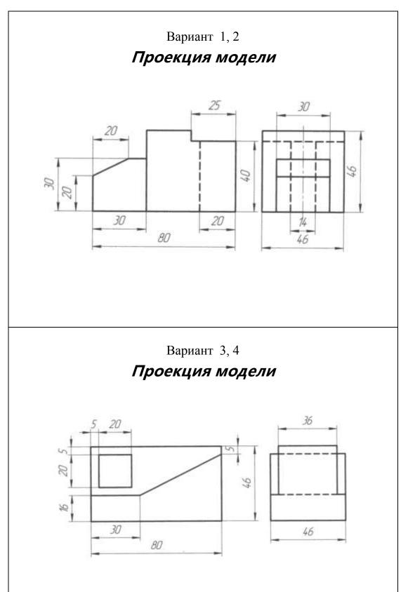
**Задание 1 Проекция модели (В программе КОМПАС)** Построить третью проекцию модели по двум данным. Нанести размеры на комплексном чертеже Построить изометрическую проекцию этой модели.
