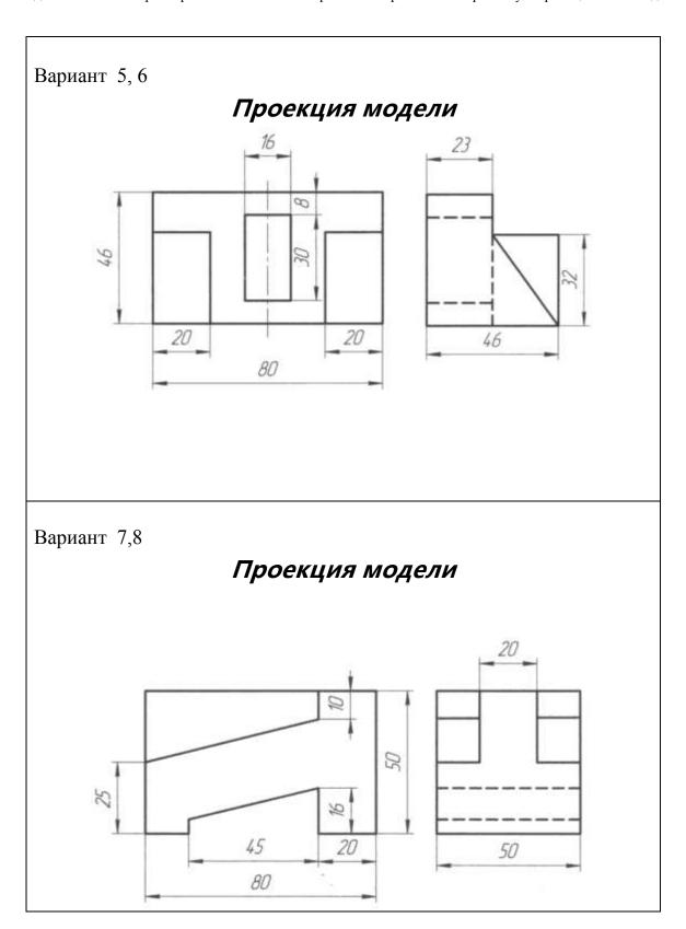
**Задание 1 Проекция модели (В программе КОМПАС)** Построить третью проекцию модели по двум данным. Нанести размеры на комплексном чертеже Построить изометрическую проекцию этой модели.
