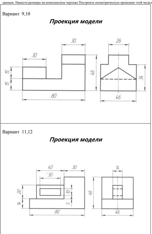
**Задание 1 Проекция модели (В программе КОМПАС)** Построить третью проекцию модели по двум данным. Нанести размеры на комплексном чертеже Построить изометрическую проекцию этой модели.
