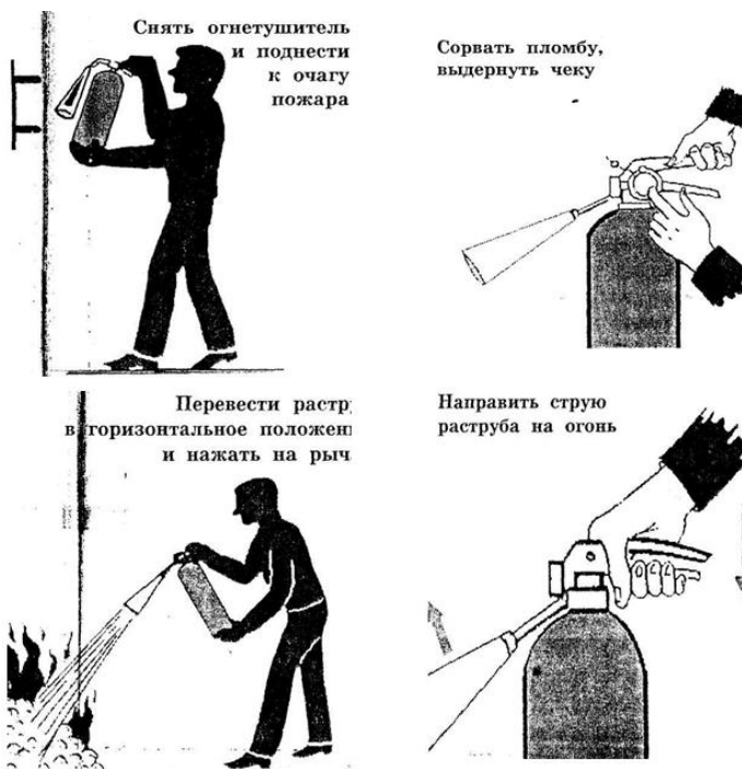
Рис. 3. Приведение в действие ручного углекислого огнетушителя.
