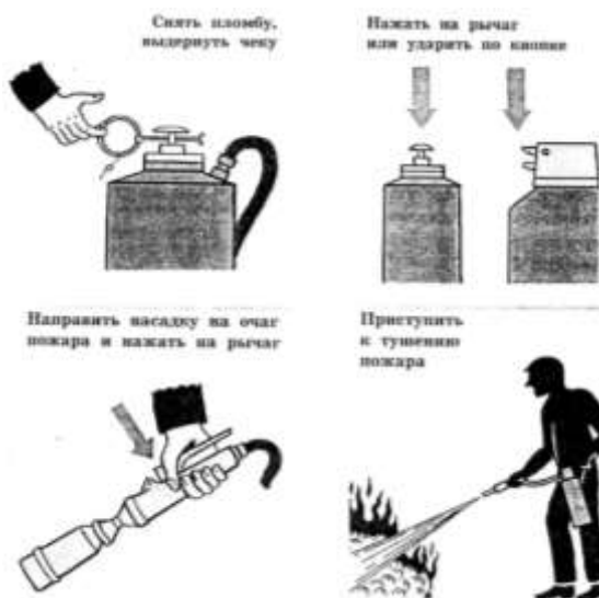
Рис.1. Приведение в действие воздушно-пенного огнетушителя.
