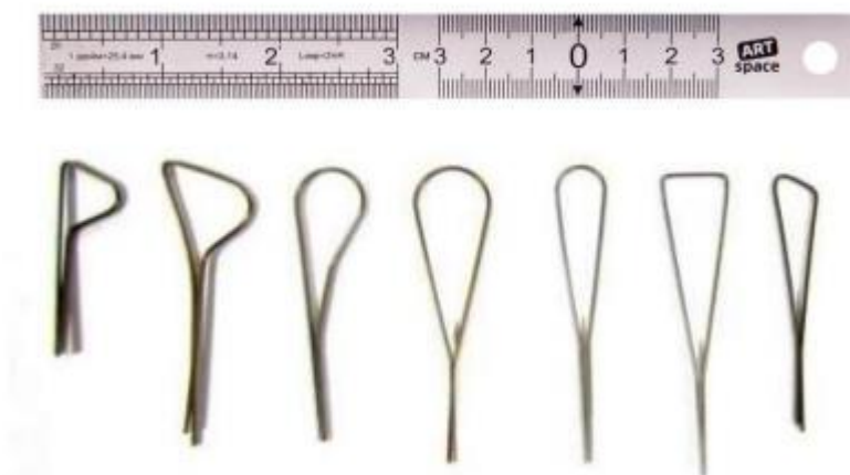
Рис. 2б. Набор насадок петли-проволока средние – приспособления для работы с пластилиновым воском
