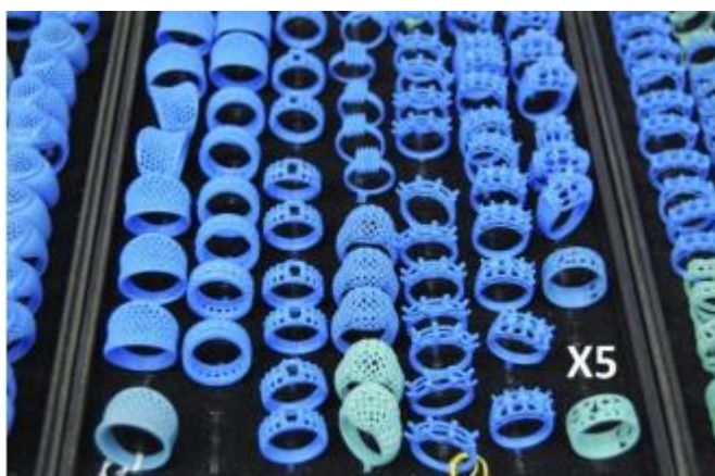
Рис. 3. Пример наращенных в 3D-принтере мастер-модели из воска
