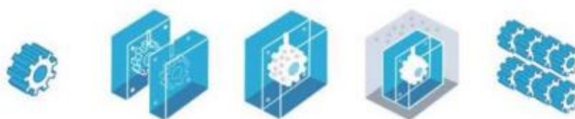
Рис.1. Технологическая схема литья в силиконовые формы: изготовление мастер-модели - снятие силиконовой формы - литье металла (модельного воска) - дегазация в вакуумной камере - отправка готовой партии отливок (моделей).
