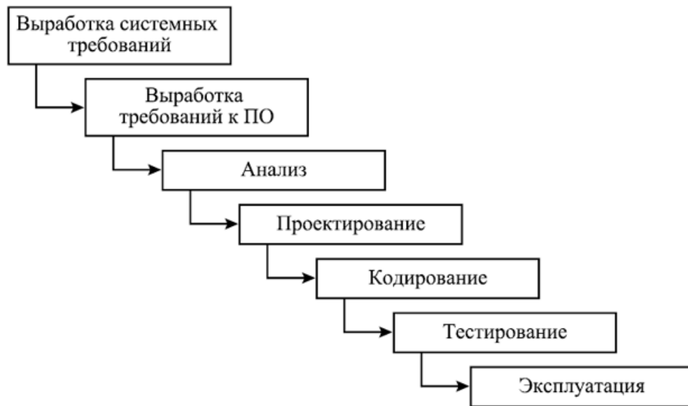
Рисунок 1. Каскадная модель жизненного цикла Web-приложения
