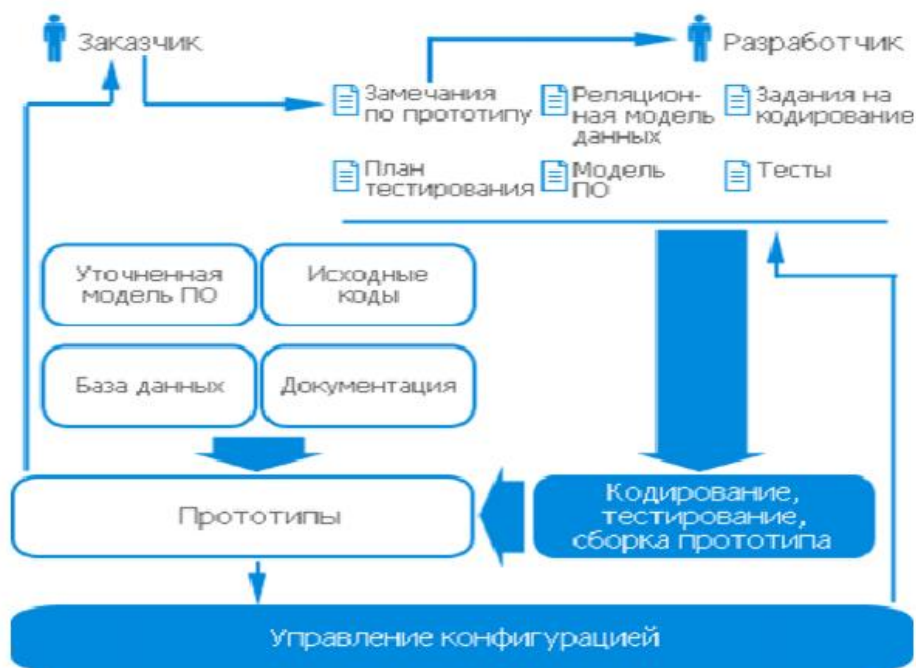
Рисунок 1. Структуру метода прототипирования
