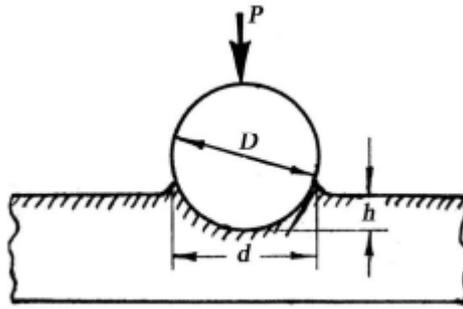
Рис. 1. Схема испытания твердости методом вдавливания стального шарика
