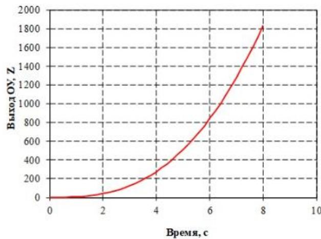
10. Определите по графику коэффициент передачи объекта с самовыравниванием
