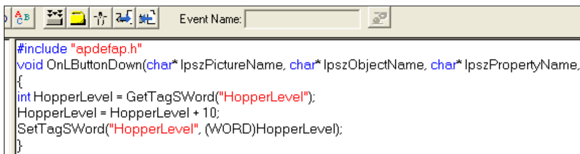
Рис. 12. Пример изменения значения аналогового тэга на C
