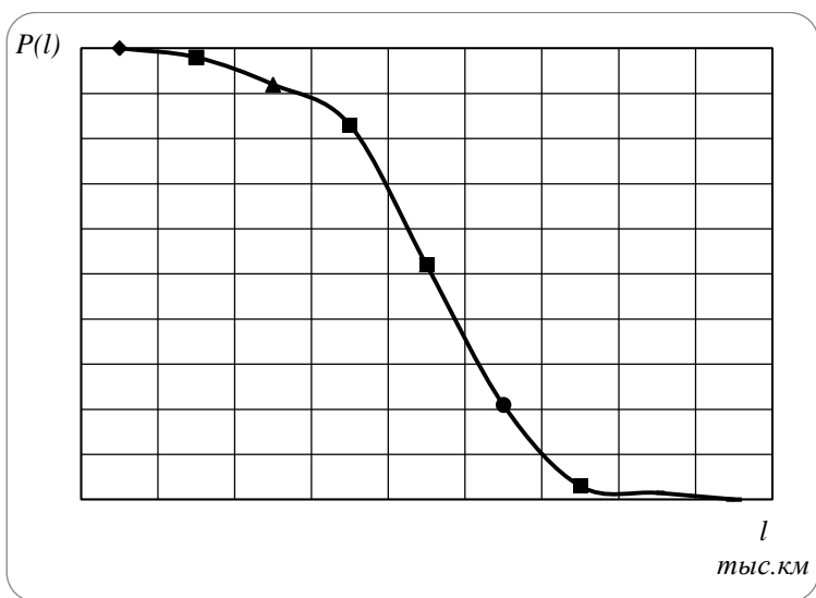
Рис. 3 Кривая вероятности безотказной работы детали P(l) зависимости от наработки l .
