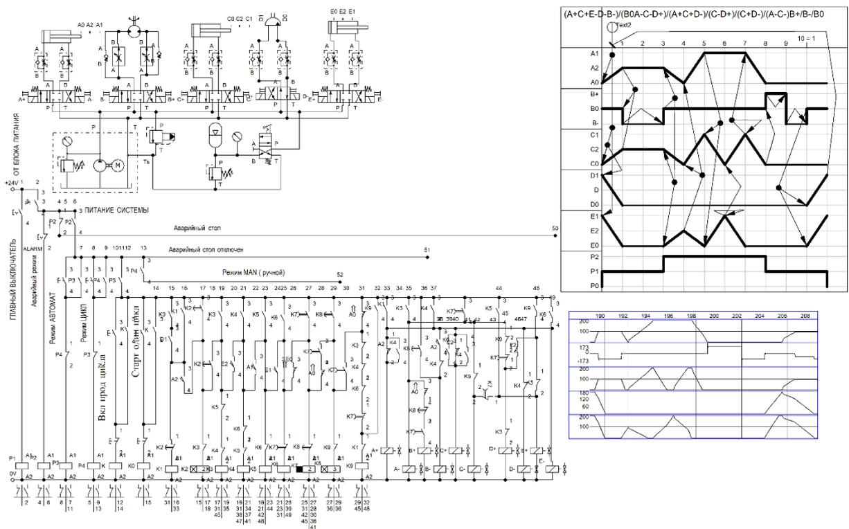
гидроприводом автоматической линии по заданной циклограмме
