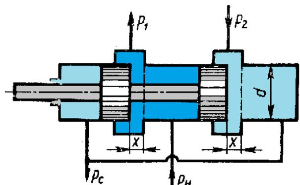
силы пружины  $F_{пр}$  регулятор будет обеспечивать расход  $Q = 5$  л/мин, если диаметры  $D = 20$  мм,  $d = 3$  мм; коэффициенты расхода дросселирующих отверстий  $\mu = 0,8$ , плотность рабочей жидкости  $\rho = 900$  кг/м<sup>3</sup>. Считать, что в пределах рабочего хода плунжера сила пружины остается-постоянной.
