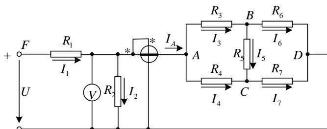
2. Заменить треугольник, состоящий с резисторов  $R_3$ ,  $R_4$ ,  $R_5$  эквивалентной звездой.
