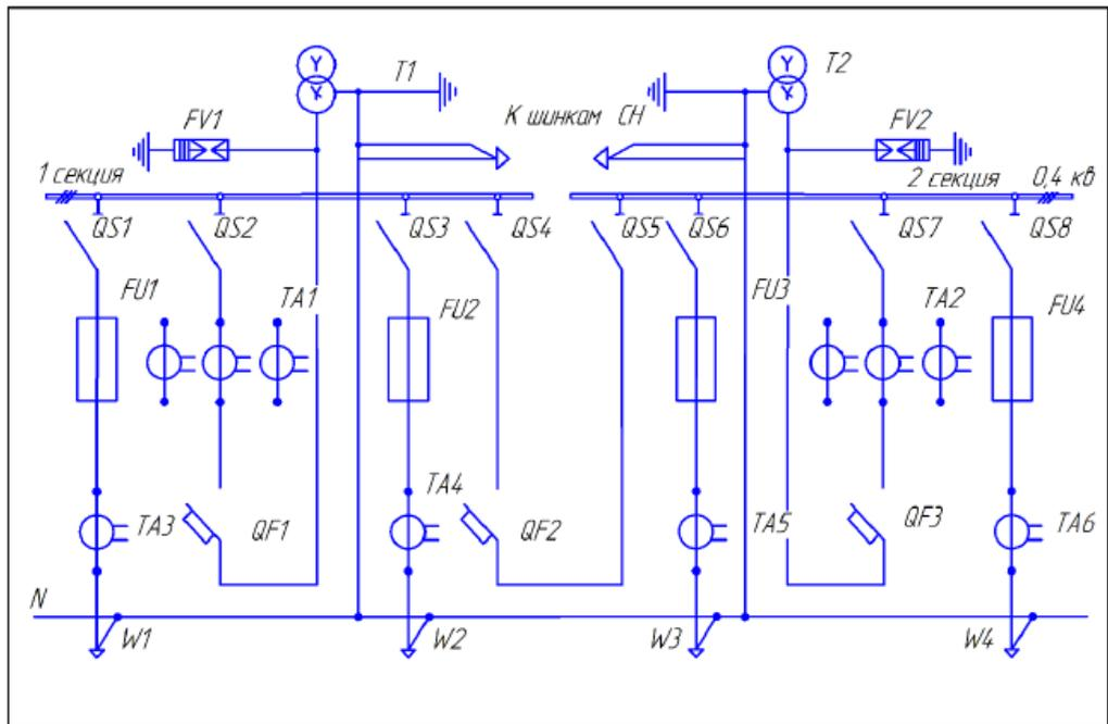
Схема главных электрических соединений РУ 0,4 кВ ТП с АВР на стороне 0,4 кВ
