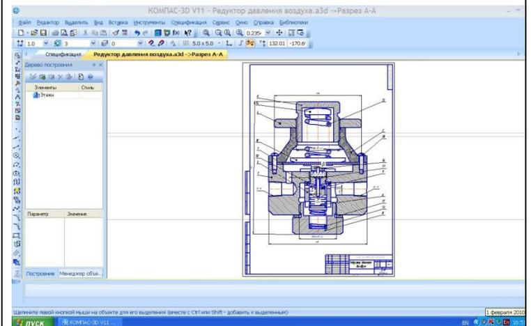
7. Сборочный чертеж узла.
