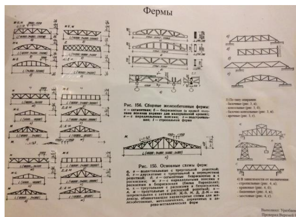
Рис.5. Фермы: (конструкции большепролетных зданий)
