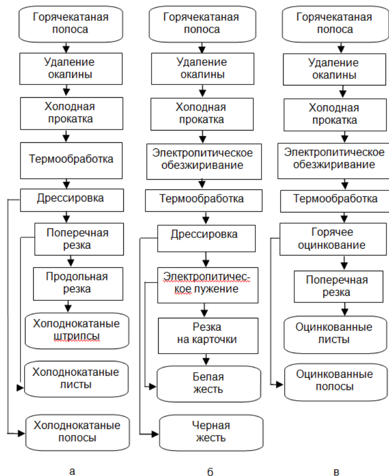
Схемы технологического процесса производства холоднокатаной листовой стали:
