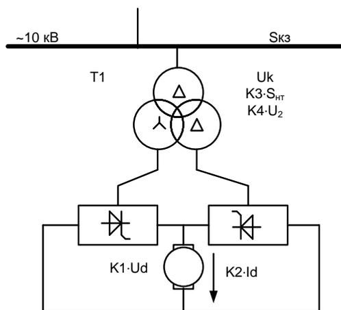
Рис. 3. Двухмостовая схема с двумя параллельно включенными преобразователями
