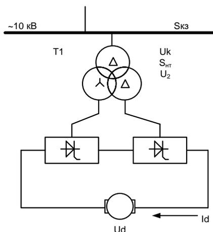
Рис. 2. Двухфазовая схема с двумя последовательно включенными преобразователями
