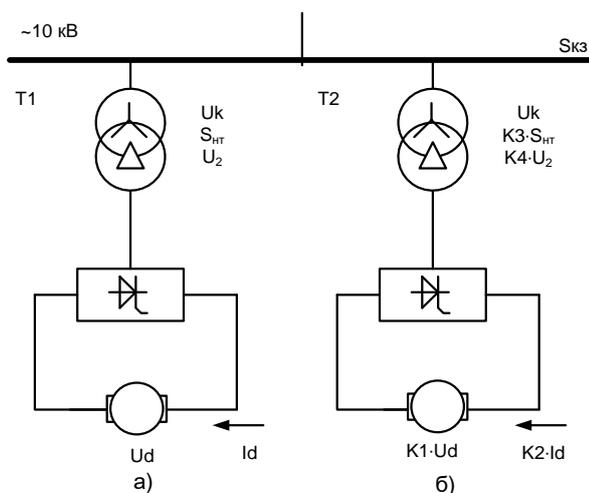
Рис 1. Схемы присоединения однофазовых ТП к сети 10 кВ
