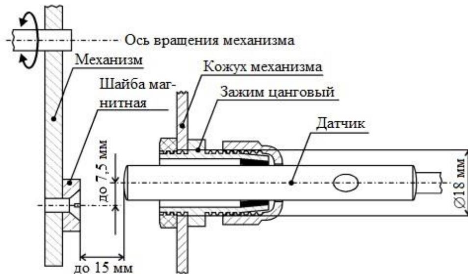
Рис.13. Принцип работы датчика движения
