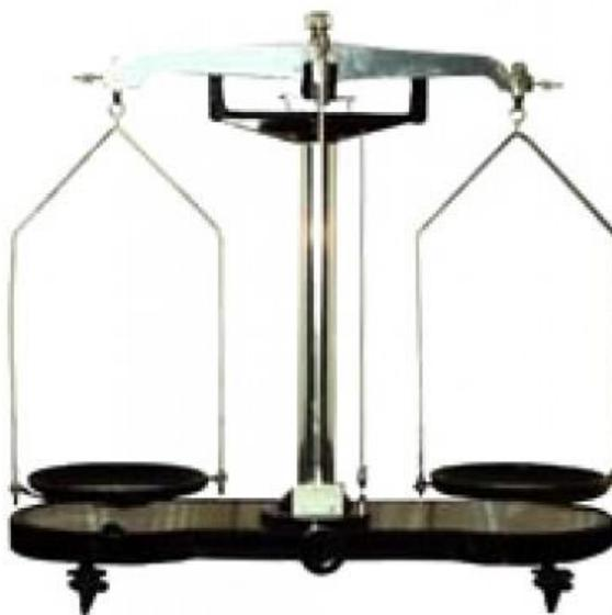
Рисунок 2 – Технические весы
