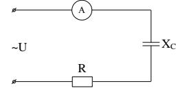
3. Определить действующее значение тока, напряжения, сдвиг по фазе и характер нагрузки, если мгновенные значения тока и напряжения равны:  $i = 10 \sin \omega t$ ,  $u = 141 \sin(\omega t + 30^\circ)$ .
