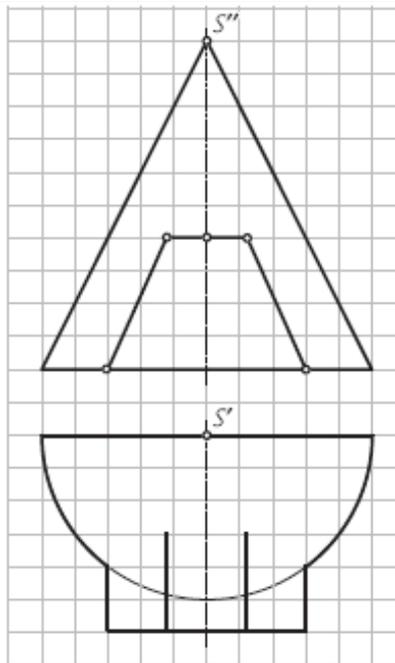
6. Достроить горизонтальную проекцию линии пересечения двух геометрических тел (2й частный случай).
