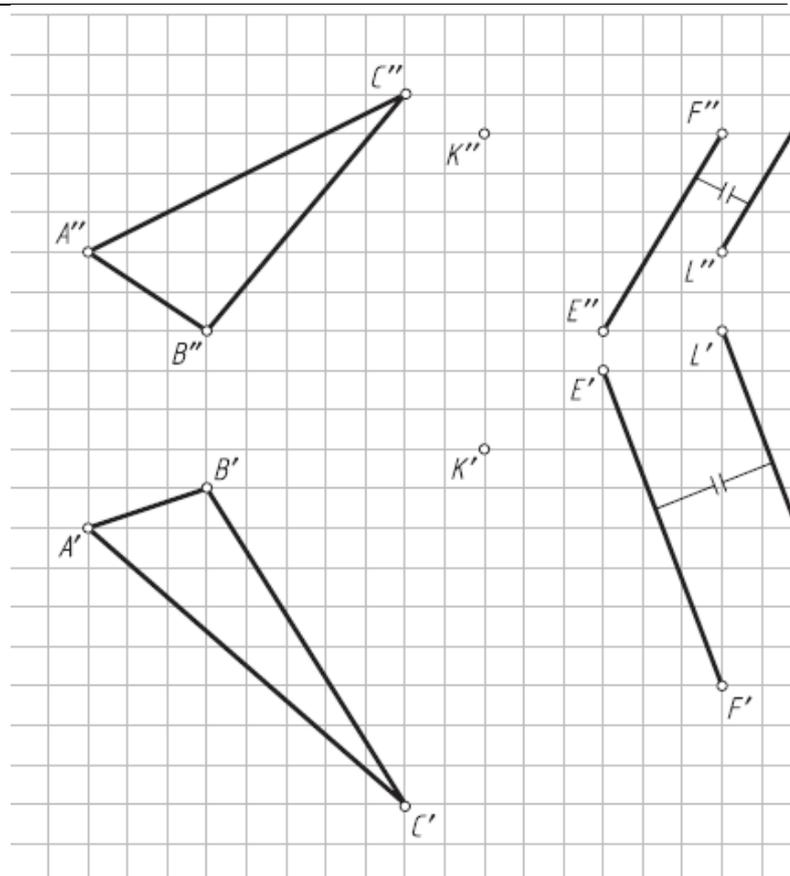
14. Определить расстояние от точки В до прямой АС (рис. 4.14) (использовать плоскопараллельное перемещение).
