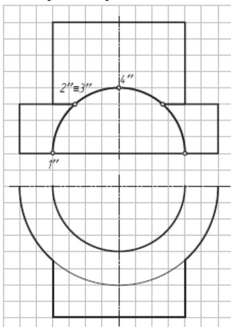
5. Достроить горизонтальную проекцию линии пересечения двух геометрических тел (2й частный случай).
