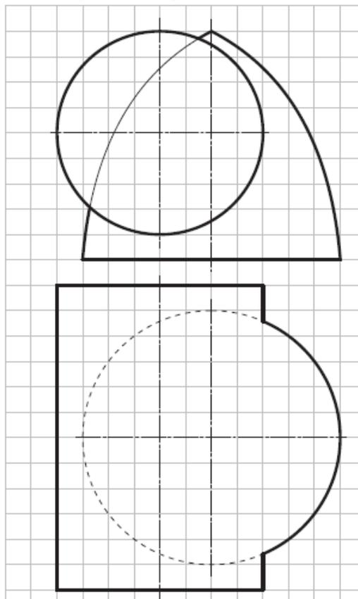
7. Достроить горизонтальную проекцию линии пересечения поверхностей двух геометрических тел (2й частный случай).
