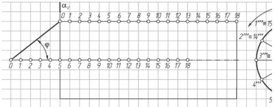
Построить на профильной проекции геликои́да его сечение профильной плоскостью  $\alpha$  ( $\alpha_V$ ). Построить фронтальную проекцию линии MN, лежащей на поверхности геликои́да.
