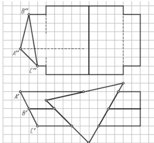
9. Достроить горизонтальную проекцию линии пересечения поверхностей двух геометрических тел (одностороннее касание—2й частный случай).
