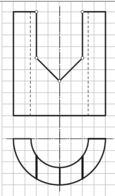
3. Построить горизонтальную проекцию комбинированного геометрического тела (1й частный случай).
