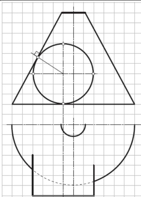
10. Достроить линии пересечения соосных поверхностей (3й частный случай).
