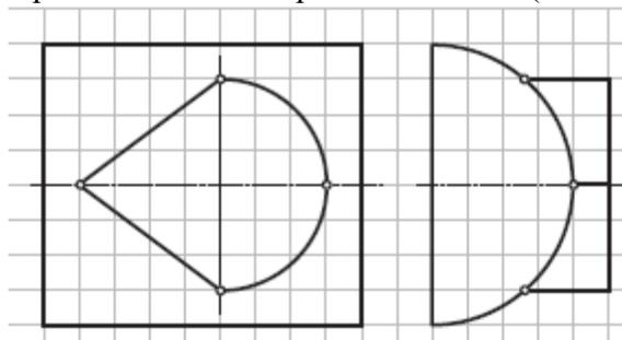
4. Достроить горизонтальную и построить профильную проекции комбинированного геометрического тела (пересечение трех поверхностей, 1й частный случай).
