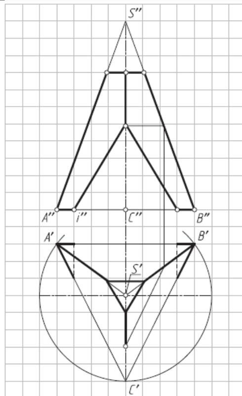
4. Построить половину развертки боковой поверхности конуса со срезом (горизонтальную проекцию не достраивать).
