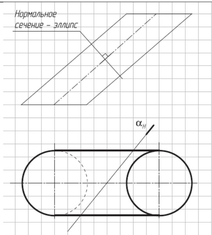
9. Построить фронтальный след цилиндрической поверхности  $\phi(S, m)$ .
