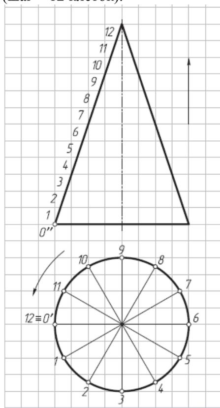
3. Достроить фронтальную проекцию прямого геликоида с правой винтовой направляющей линией (на рис. показаны фронтальная и профильная проекции) и недостающие проекции точек К и N на поверхности геликоида.
