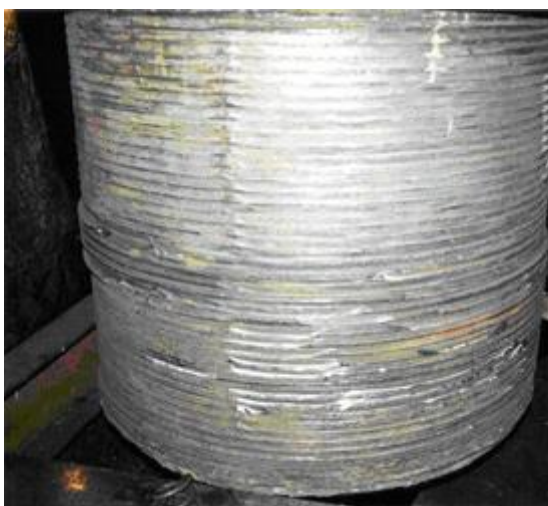
Рис. 3. Разрушение внешней резьбы колонны под основанием прессы силой 100 МН для изготовления ж/д колес. Диаметр колонн 830 мм
