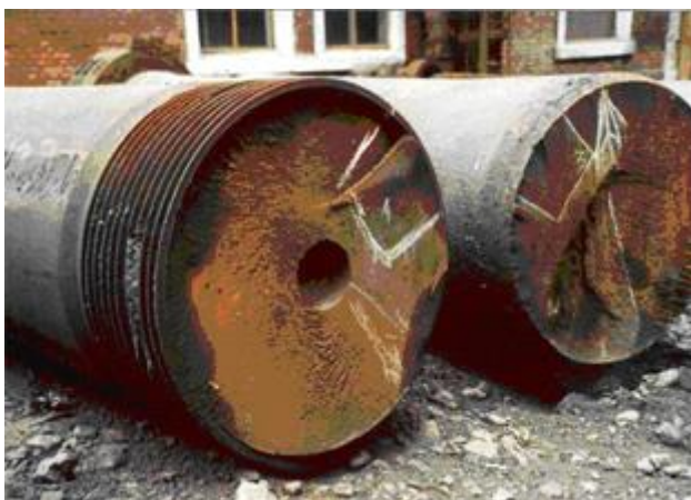
Рис. 2. Поверхности излома разрушенных колонн прессы силой 70 МН для изготовления ж/д колес. Диаметр колонн 600 мм
