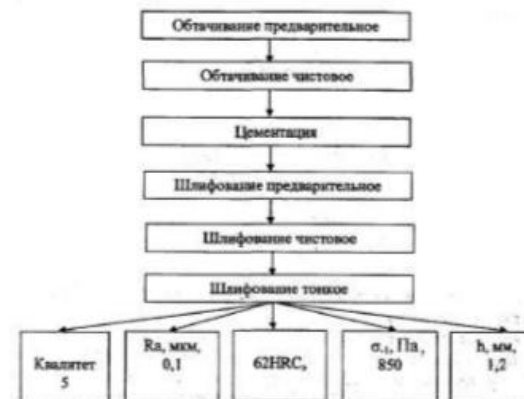
Рис. 2.15.1. Схема комплекса способов и результатов обработки наружной цилиндрической поверхности
