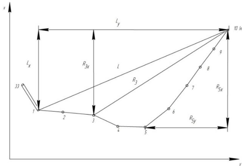
Рис. 4.1. Схема к предрасчету точности конечного пункта свободного теодолитного хода
