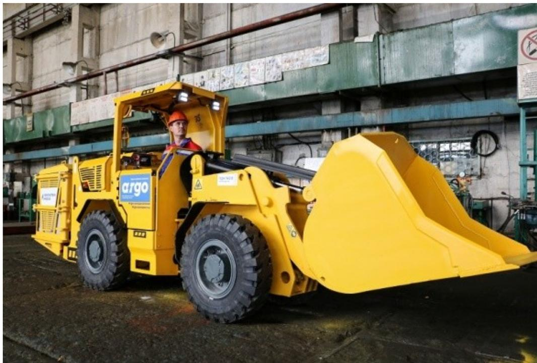
ARGO ПДМ 140 Б разработана для подземных работ на узкожилых месторождениях. Она имеет ширину 1,1 метра, грузоподъемность ковша 1,3 тонны. Двигатель мощностью 50 кВт и блок ионно-литиевых батарей обеспечивают высокую мобильность, автономную работу до четырех часов, низкий уровень шума, минимальную теплоотдачу, отсутствие загазованности в забое. Машина значительно превосходит требования российских стандартов в сфере промышленной безопасности.
