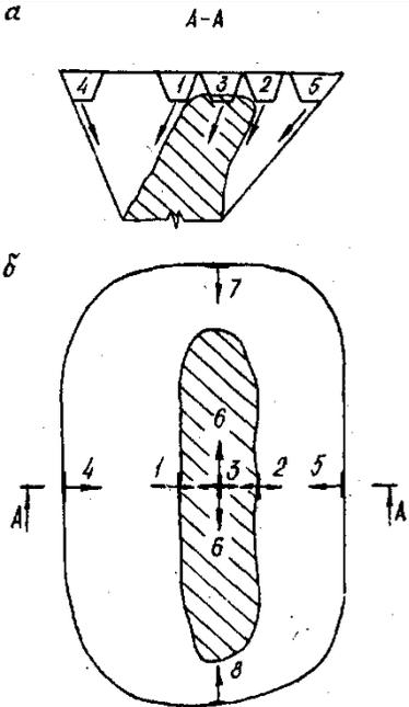
Рис. 10.1. Варианты начального положения фронта работ при отработке наклонных и крутых залежей
