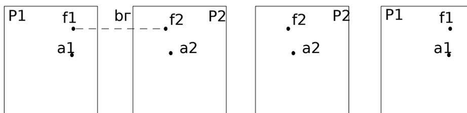
**Рис. 8.3. Схемы расположения снимков для получения а - прямого стереоэффекта, б - обратного**
