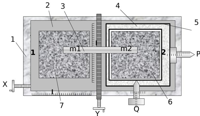
Рис. 8.6 Схема стереокомпаратора
