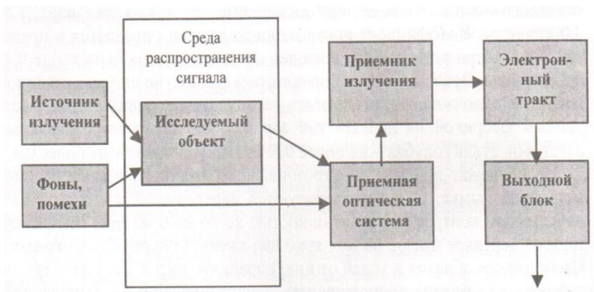
Источник излучения создает материальный носитель полезной информации – поток излучения. Этим источником может быть сам исследуемый объект. Приемная оптическая система собирает поток, излучаемый наблюдаемым объектом или отраженный от него, формирует этот поток и направляет его на приемник излучения. Приемник превращает сигнал, переносимый потоком излучения, в электрический. Выходной блок формирует сигнал, по своим параметрам удовлетворяющий требованиям получателя информации.
