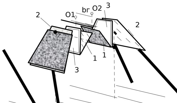
Рис. 8.4. Линзово-зеркальный стереоскоп
