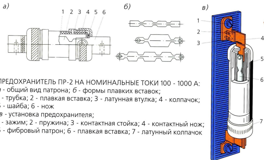
Рис. 2.3 Предохранитель ПР-2
