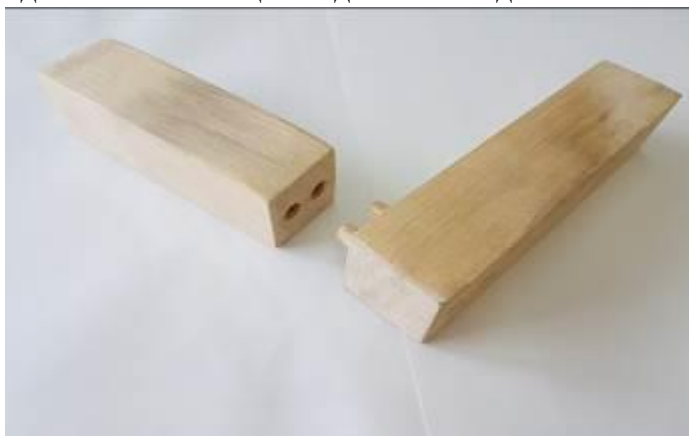
Задание 6. Тема. "Виды деревянных соединений" (Шиповые соединения деталей - на "ус" со вставными круглыми шипами).
