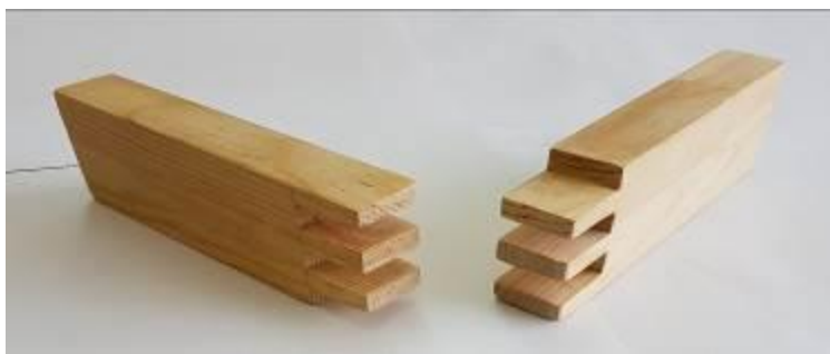
Задача 5. Тема. "Виды деревянных соединений" (Шиповые соединения деталей -
