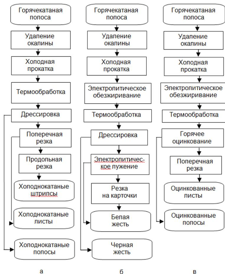
Схемы технологического процесса производства
