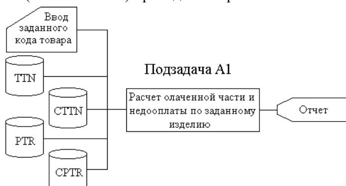
Рис. 5.4. Обобщенная функционально-технологическая схема первой подзадачи
