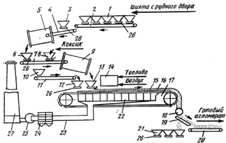
4. Описать устройство и работу конвейерной агломерационной машины.
