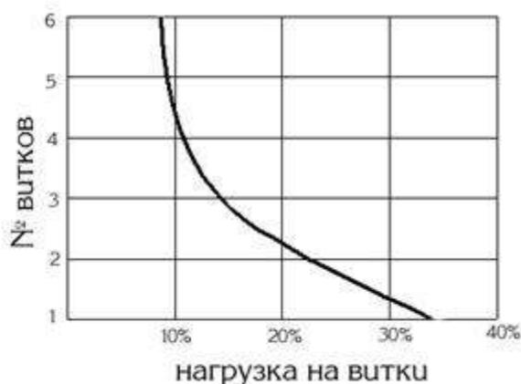
Рис. 1. График распределения нагрузки по виткам резьбы M24x3
