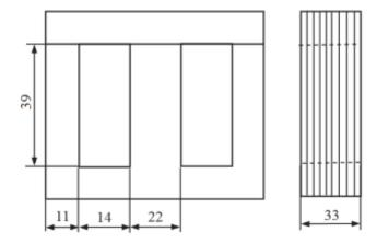
Броневой пластинчатый магнитопровод трансформатора с размерами в миллиметрах
