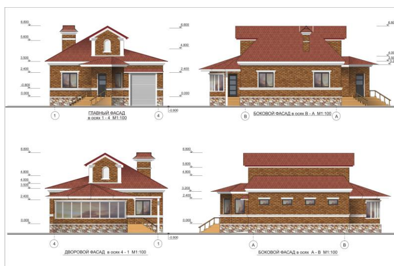
Рис. 5 Выполнение фасадов здания (компьютерная графика)
