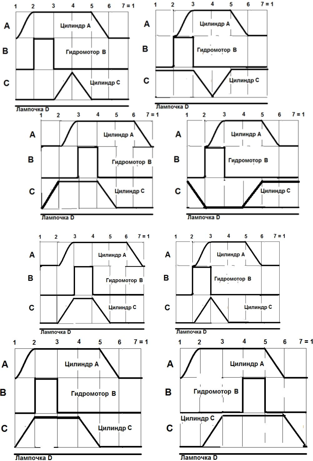
**Задание 2.** Согласно заданной диаграммы перемещения разработать системы управления: 1 - используя релейно-контактные схемы; 2 - используя (симулятор) контроллера в программе FluidSim-H.
